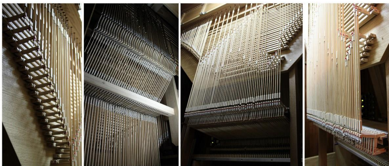
■ il.20. Traktura mechaniczna organów.
