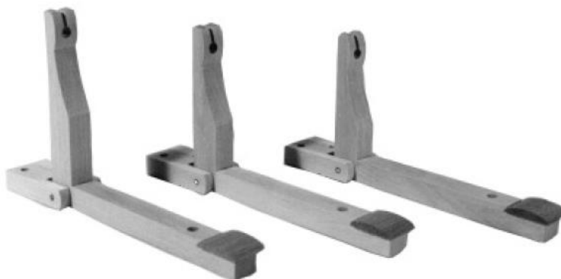
■ il.8. Kątowniki stosowane w trakturze gry pedału.
