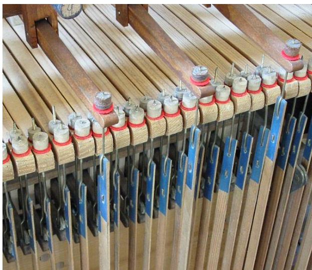
■ il.17. Elementy regulacyjne mocowane na druczianych zakończeniach abstraktów.
