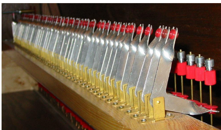
■ il.4. Kątowniki metalowe w układzie traktury (w trakcie montażu).
